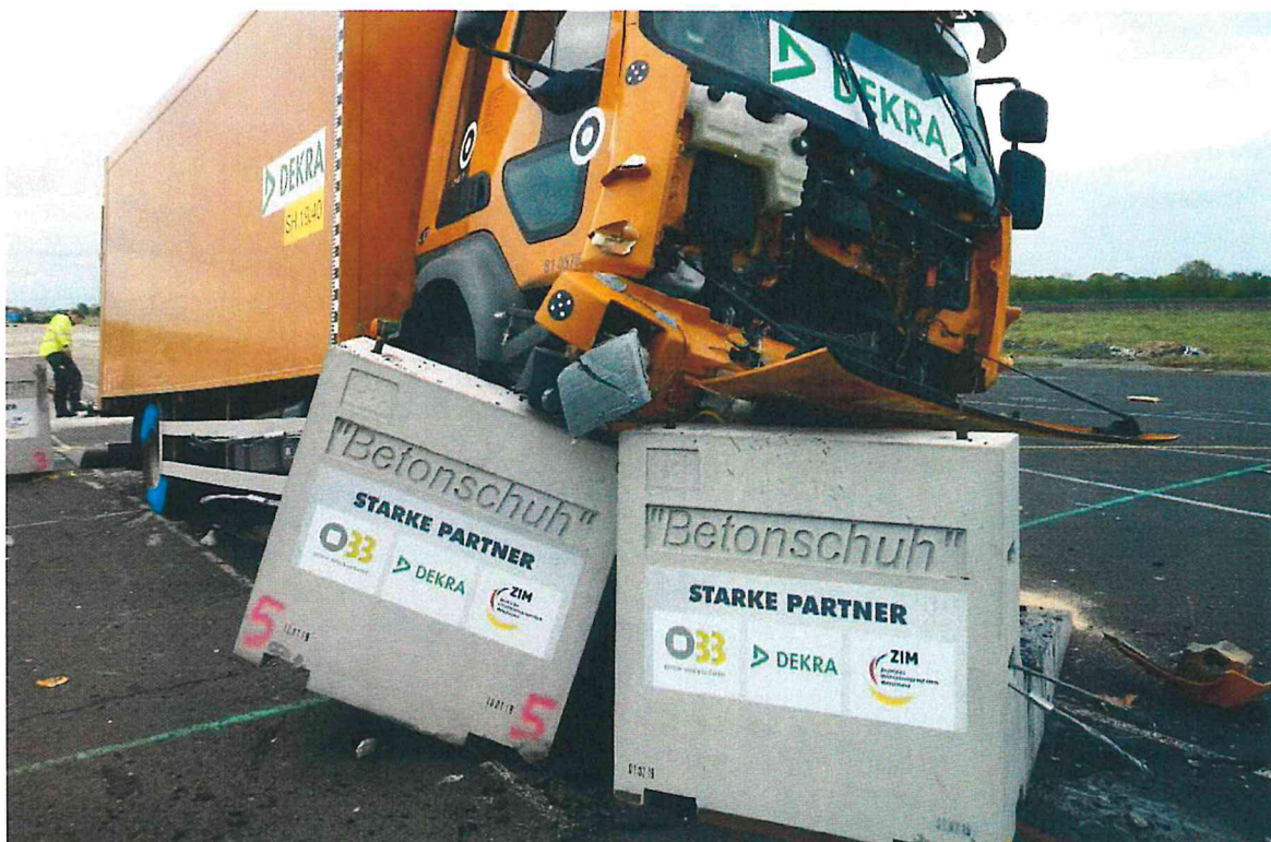
Bild 10: Endlage nach dem Anprall
