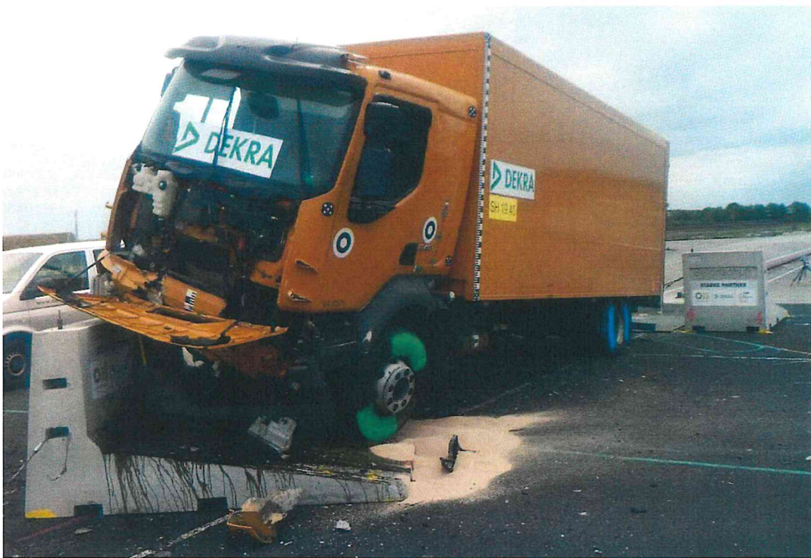
Bild 9: Endlage nach dem Anprall
