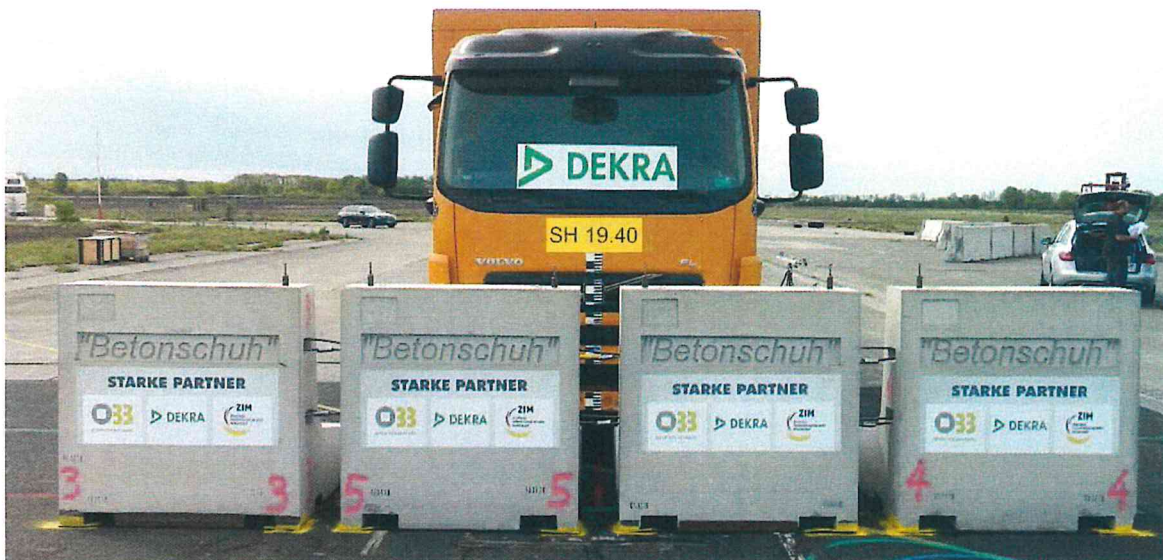
Bild 7: Stellprobe am erwarteten Anprallpunkt
