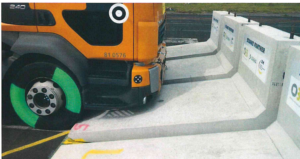
Bild 8: Stellprobe am erwarteten Anprallpunkt
