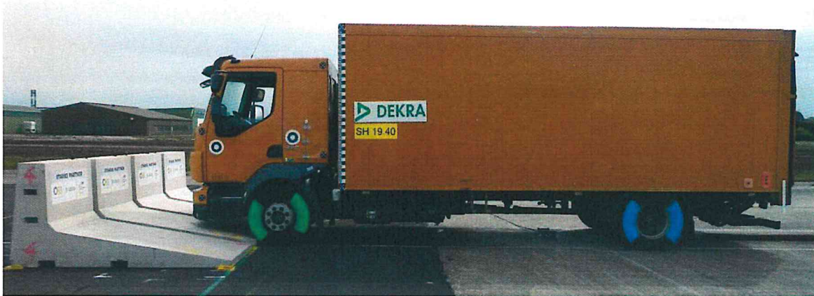
Bild 6: Stellprobe am erwarteten Anprallpunkt
